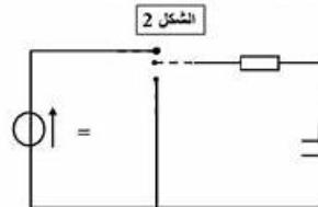
يستخدم مثبت التوتر ( ) في حماية أجهزة الكمبيوتر من التغيرات العجائية للتوتر الكهربائي، تغير المكثف أحد مكوناته الرئيسية. يهدف هذا التمرين إلى تعين المقدار المميز لهذه المكثف. يهدف تعين المقادير المميزة لمكثف مثبت التوتر، تركيب دارة كهربائية سهلة كما يمثله الشكل .
